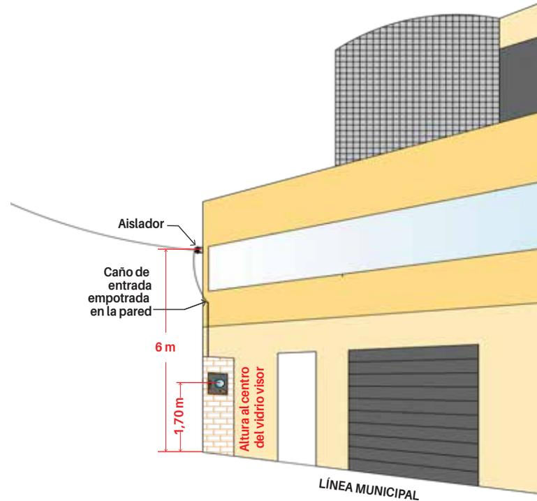
La distancia máxima entre el puesto de medición y la red eléctrica de CRE debe ser 20 metros.
